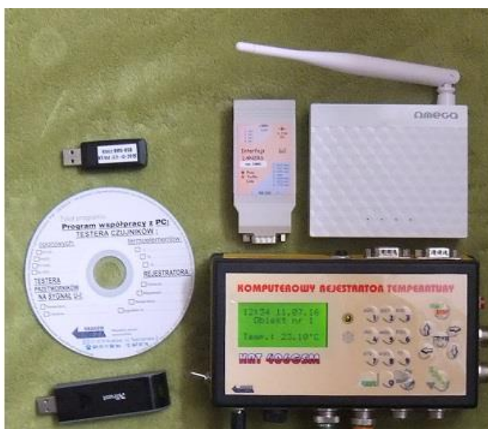
Fot. Zestaw bezprzewodowego systemu pomiarowego WiFi z czterokanałowym modułem pomiaru temperatury.
